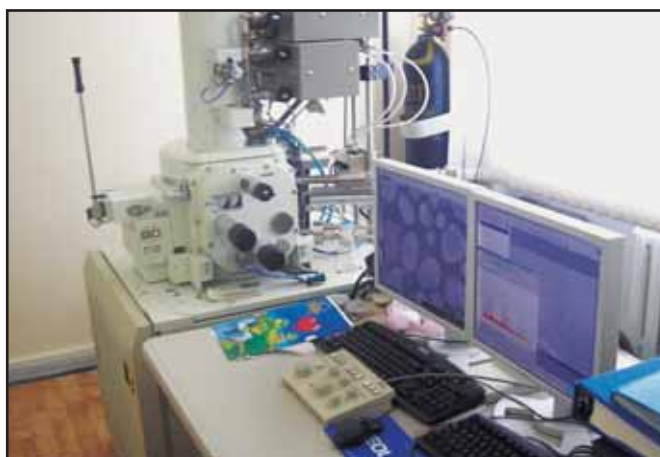
Рисунок 1. Внешний вид сканирующего электронного микроскопа JEOL JSM 6700F с приставкой EX-23000 BU для энергодисперсионного анализа (с панелью и экранами управления)
